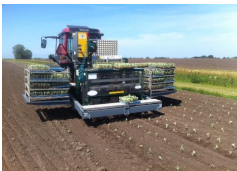
Vollautomatische Pflanzmaschine für Traypflanzen
