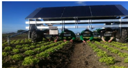
Selbstfahrende Jätmaschine mit Solarstromantrieb für den Bio-Gemüseanbau
