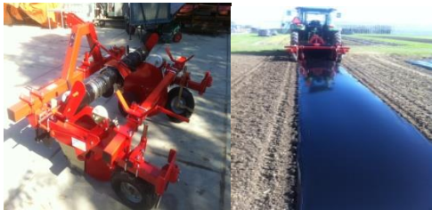
Folienlegemaschine für schnelle und einwandfreie Verlegung von Mulchfolien
