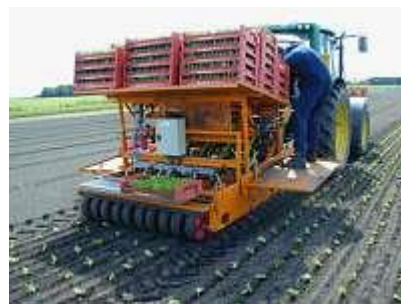
neue Bänderpflanz- maschine für Presstöpfе von Regero
